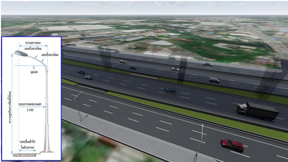
รูปที่ 5.7-1 การติดตั้งเสาไฟฟ้าแสงสว่างของโครงการ
